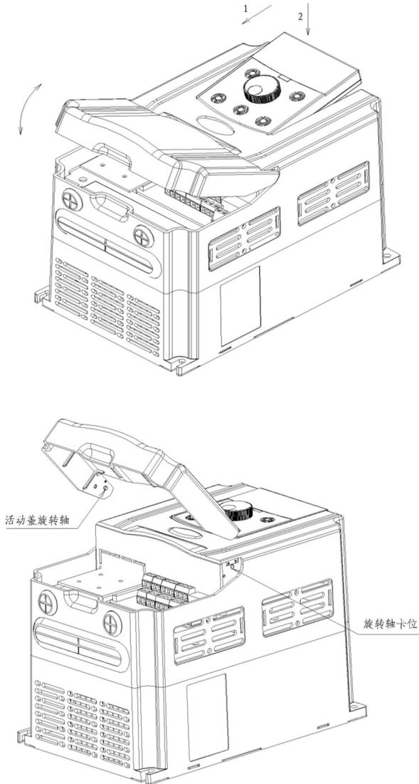
图 3-2 塑胶外壳下盖板拆卸图
