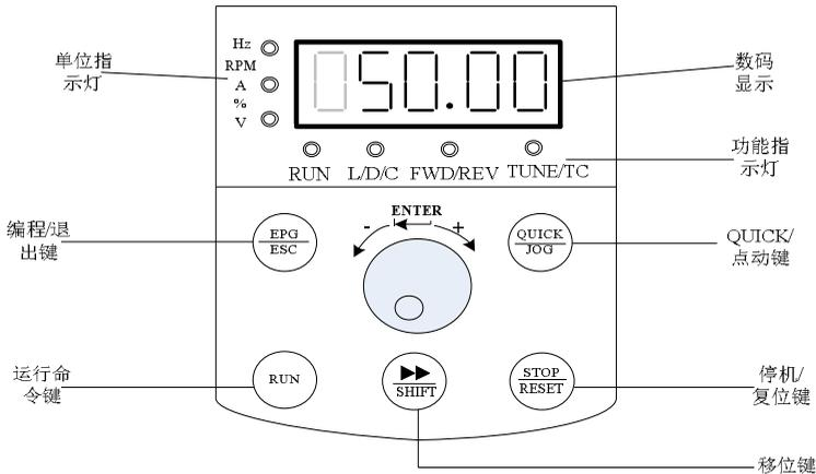
图 4-1 操作面板示意图 1(标准配置 LED 键盘 1)
