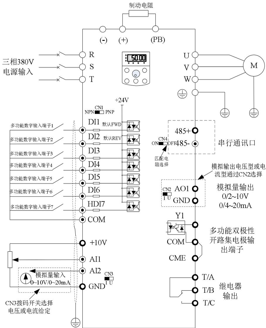
图 3-4 30kW 以下内置制动单元三相变频器
