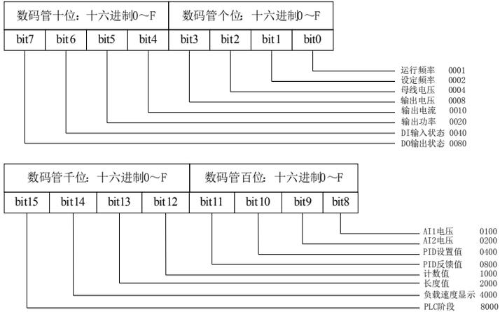
图 5-17. LED 运行显示位对应图
