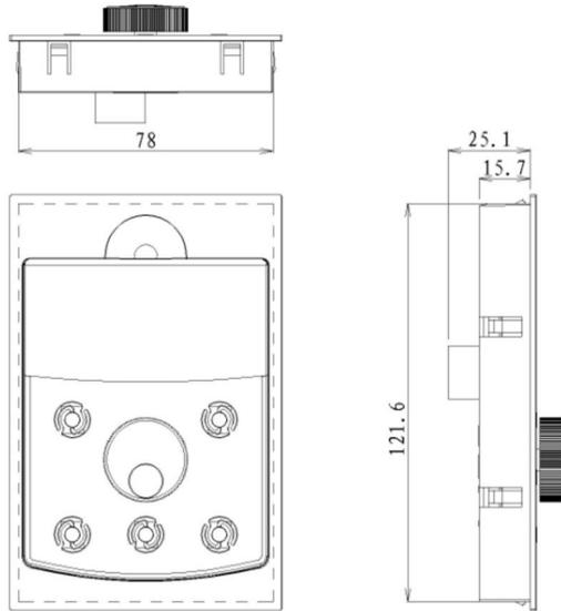
图 2-6 外引键盘带托盘安装尺寸示意图
