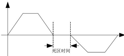
图 5-14. 正反转死区时间示意图
