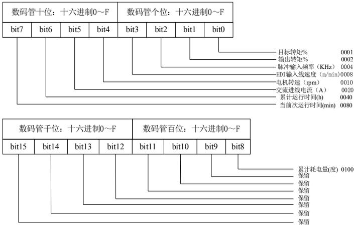
图 5-20. LED 运行显示位对应图
