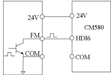
高速脉冲输入输出作为多台变频器之间的同步控制，较用模拟输入，输出进行同步控制，性能更好，调试更方便。
