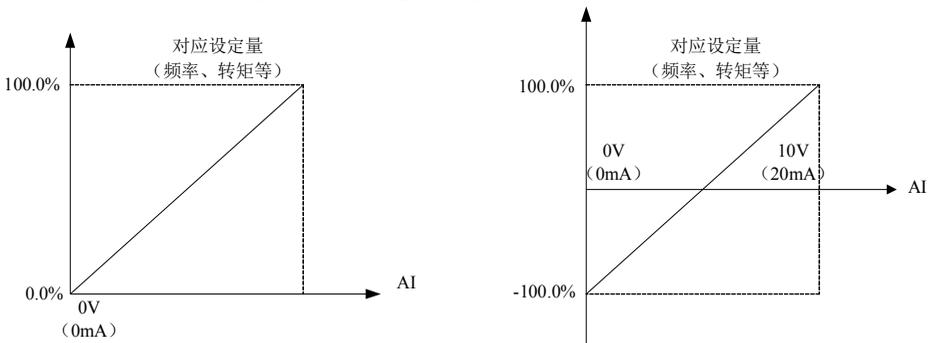
图 5-11. 模拟给定与设定量的对应关系
