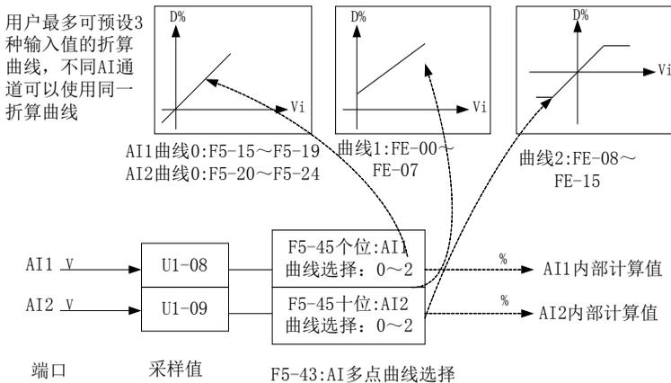
图 4-28. AI 信号对应实际给定
