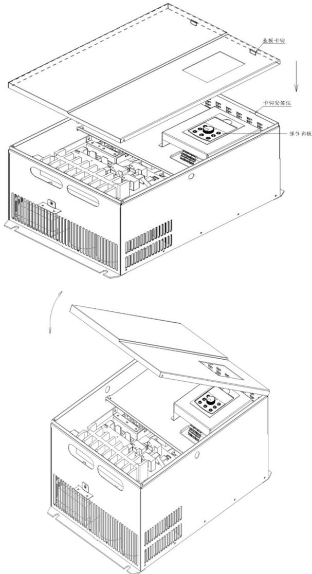
图 3-3 钣金外壳下盖板拆卸图
