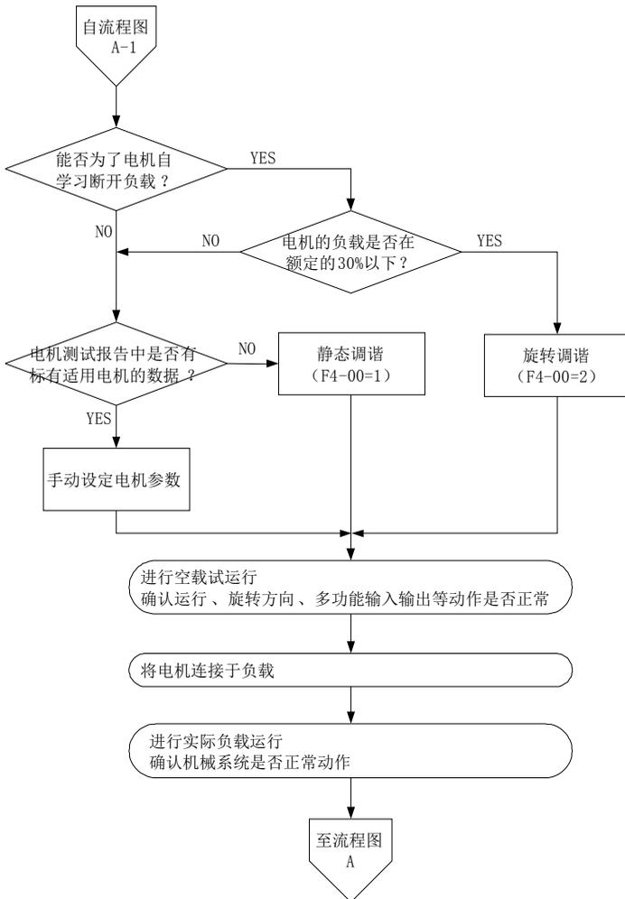
图 4-6. 闭环矢量控制方式运行步骤
