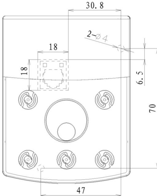
图 2-7 外引键盘不带托盘安装开孔示意图
