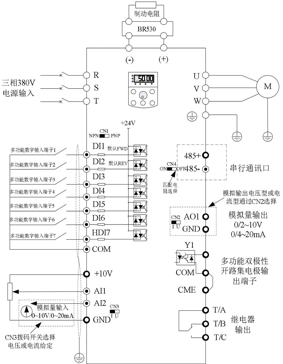
图 3-5 37kW ~ 55kW 三相变频器
