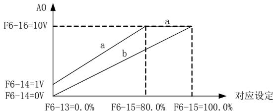
图5-12. 模拟输出上下限对应关系
