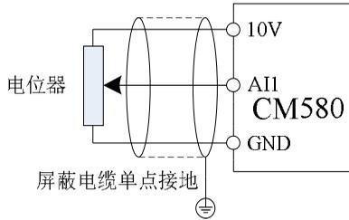
图 3-7 模拟量输入端子接线示意图
